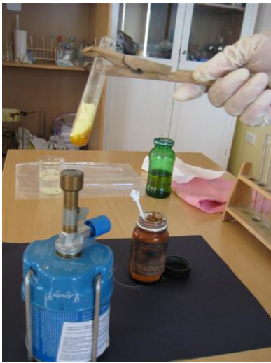
Sumpor se tali na 115^{\circ}\text{C}
